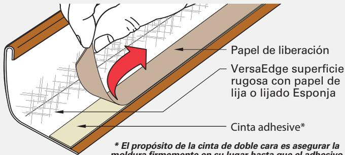
\* El propósito de la cinta de doble cara es asegurar la moldura firmemente en su lugar hasta que el adhesivo PUR cura totalmente.
