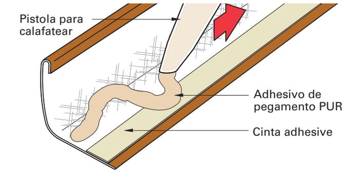
Parte de abajo de la moldura generosamente cubierta con adhesivo.
